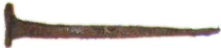
Fig. 19. Cui din grinda pridvorului, latura N, extremitatea sudică Bisericii de lemn Dragomirești, jud. Maramureș, datată în 1722, aflată din 1936 în M.N.S. "D.G."; lungimea totală de 55 mm, dimensiunile bazei 3 x 2 mm
