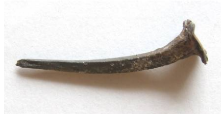
Fig. 24. Cui, datat 4/4 sec. XVIII, provenită din zona Dolj, lungime 22 mm, pătrat în secțiune, diametru floare 6 mm
