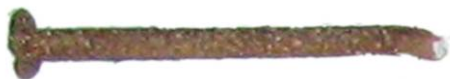
Fig. 21. Cui din pridvor, latura N, extremitatea vestică Bisericii de lemn Timișeni, jud. Gorj, datată în 1773, aflată din 2002 în M.N.S. "D.G."; lungimea totală de 30 mm, diametru 1,4 mm.
