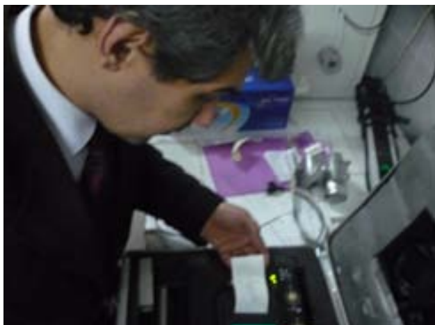
Figura 2 - Evaluarea concentrațiilor de CO, CO 2 și NO x în urma măsurătorilor efectuate cu TESTO 350 M/XL (Similară cu figura 7.1 din text)
